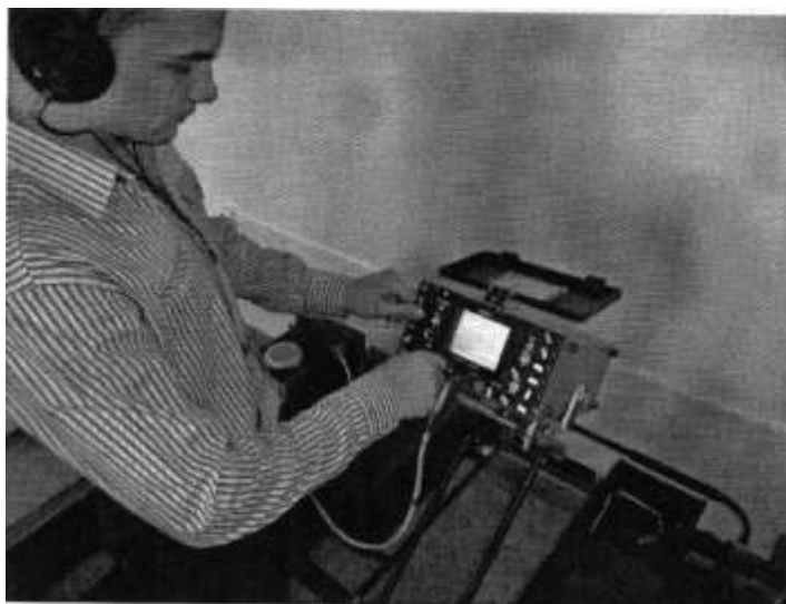
Настройка дефектоскопа «РДМ-2», лаборатория «Неразрушающий контроль рельсов»
