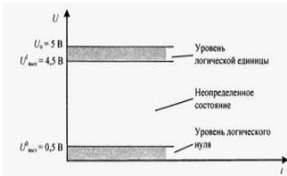
Рис. 3.20. Уровни логических сигналов на выходе цифровых КМОП-микросхем
