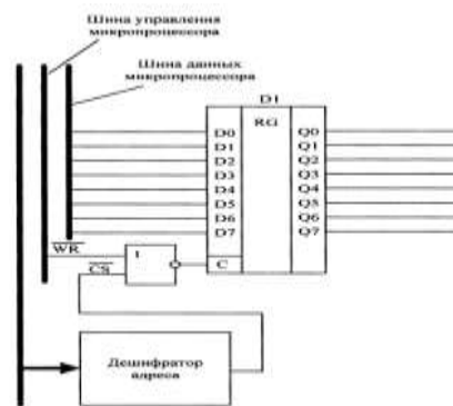
Рис. 19.6. Принципиальная схема порта вывода
