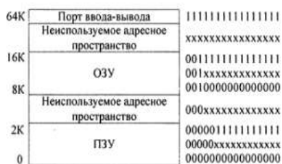
Рис. 19.5. Распределение памяти микропроцессора с 16-разрядной шиной адреса
