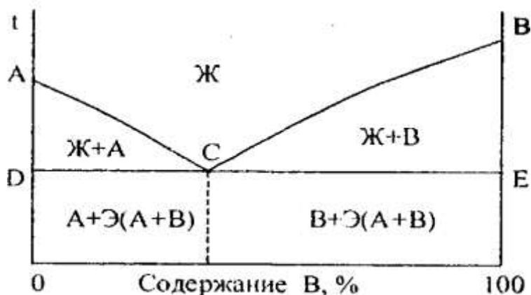
Рис. 1. Диаграмма состояния сплавов, образующих механические смеси
